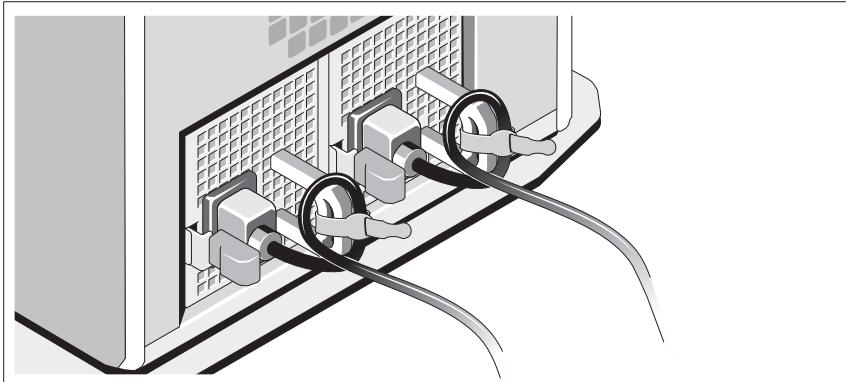
如图所示，将系统电源电缆弯曲成环状，然后使用提供的电缆带将电缆固定到支架上。
