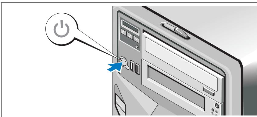
システムの電源ボタンを押します。電源インジケータが点灯します。
